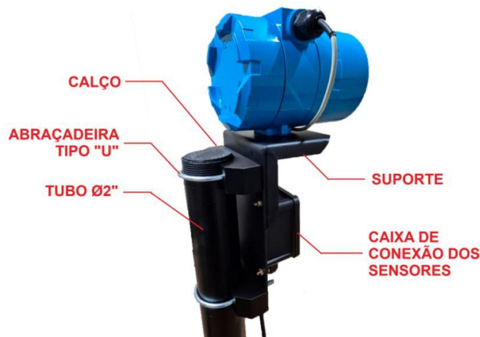
Figura 3 - Exemplo do conjunto mecânico e identificação dos principais elementos.
